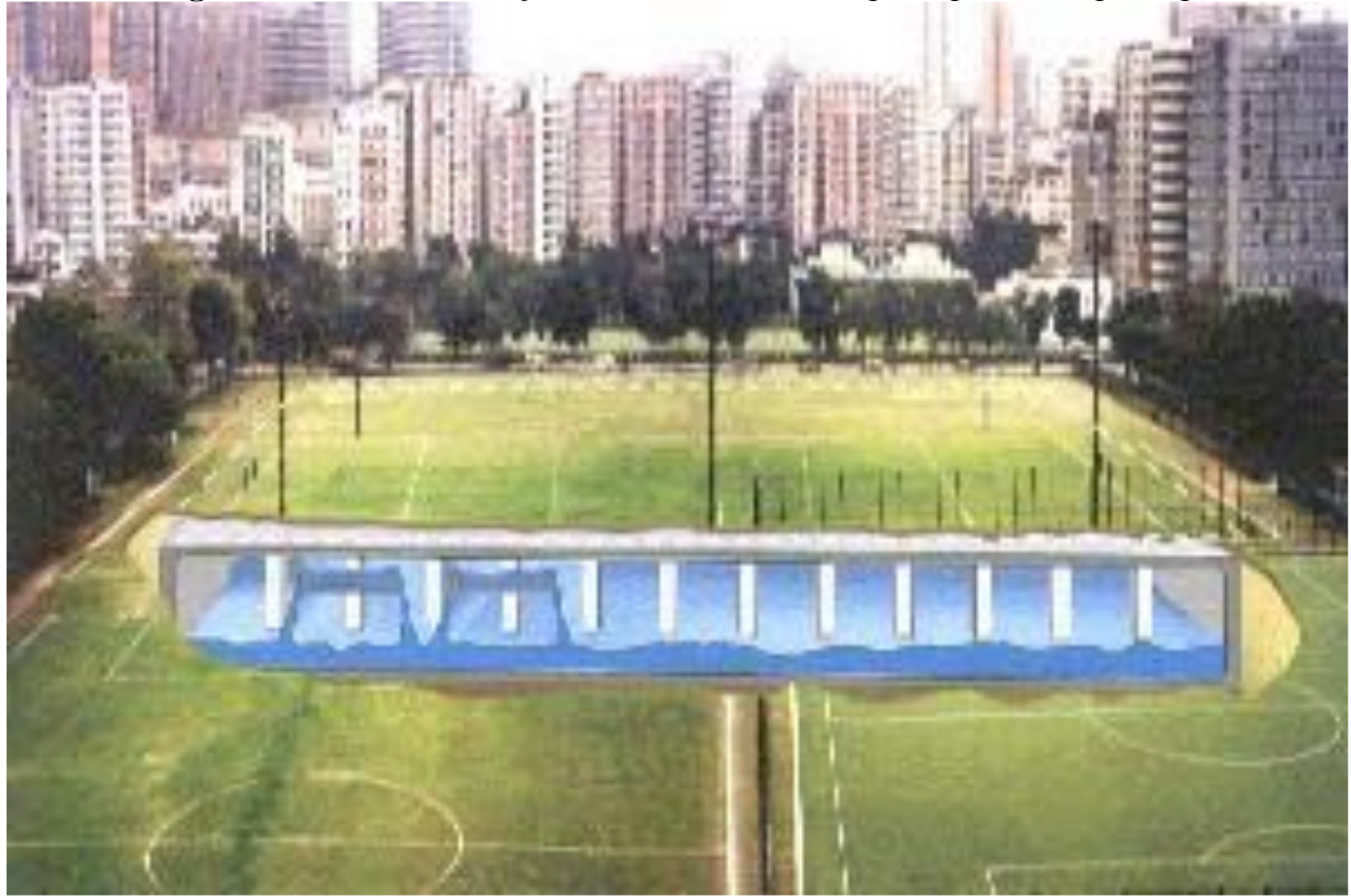
Figura 7 – Bacia de retenção enterrada de Tai Hang Tung, em Hong Kong
